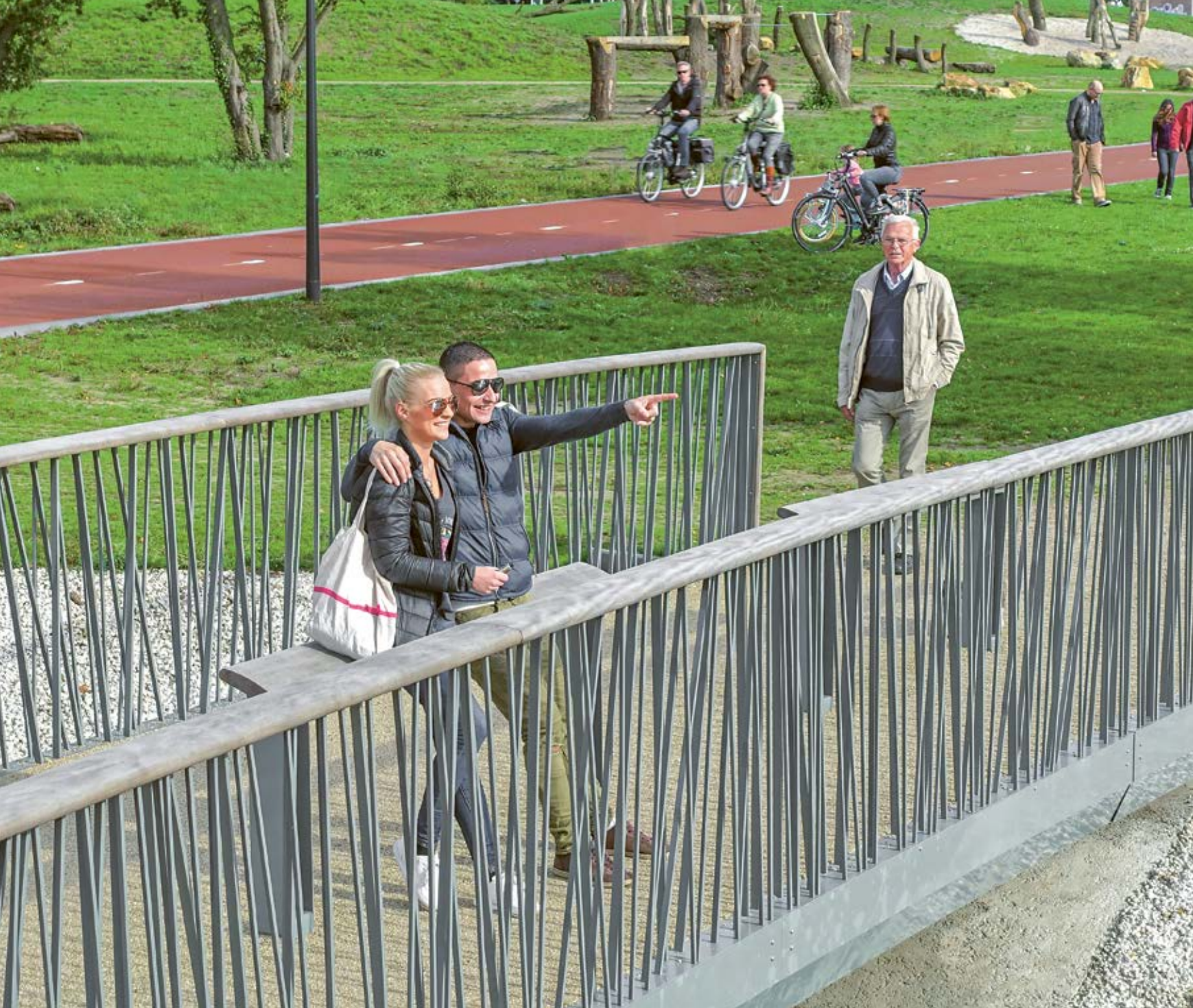
Cette Passerelle Bowie se trouve dans le Watertorenpark d’Hengelo (Pays-Bas). En acier thermolaqué, elle mesure 12 mètres pour 3 mètres de large. En son centre se trouve une sellette haute permettant au passant d’apprécier la vue sur le parc.
