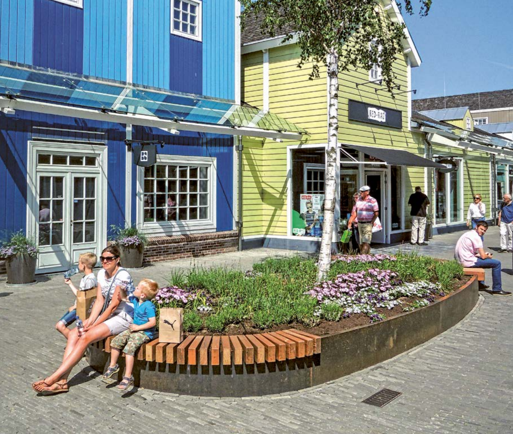
De Rough&Ready Ovale Boomeilanden in Batavia Stad Outlet Shopping, Lelystad hebben een CorTen stalen constructie en zittingen aan de twee korte zijden. Het CorTen staal komt terug in de Conische Shrubtubs die bij de winkelentrees zijn geplaatst.
