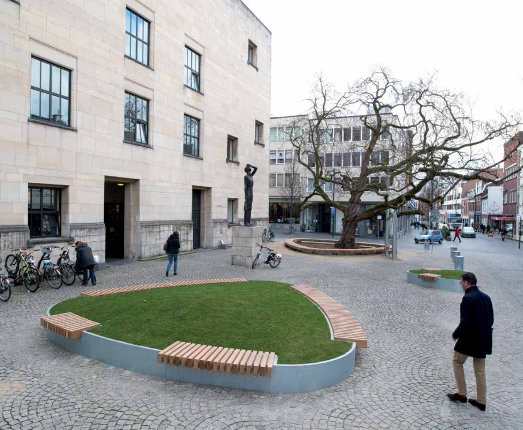
À Heerlen (Pays-Bas), un plan d'urbanisme complet a été pensé pour la Geleenstraat, dont le mobilier a été réalisé sur mesure par Streetlife. L'acier galvanisé et le bois en sont les éléments constitutifs. L'acier galvanisé est utilisé pour les îlots, une grille d'arbre sur mesure, et le piétement des bancs circulaires.
